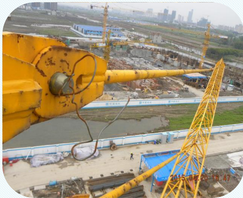
大臂拉杆销轴开口销 用铁丝代替
